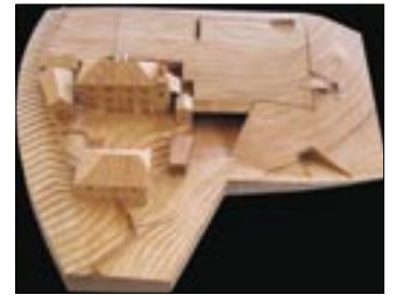
Holzmodell des Weingutes Manincor von oben. Der Keller für max. 300.000 Flaschen Produktionskapazität wurde in Tieflage unterhalb des Weinberges gebaut, wobei sich die Schräge der Decken an die Lage des Weinhangs anpasst.
