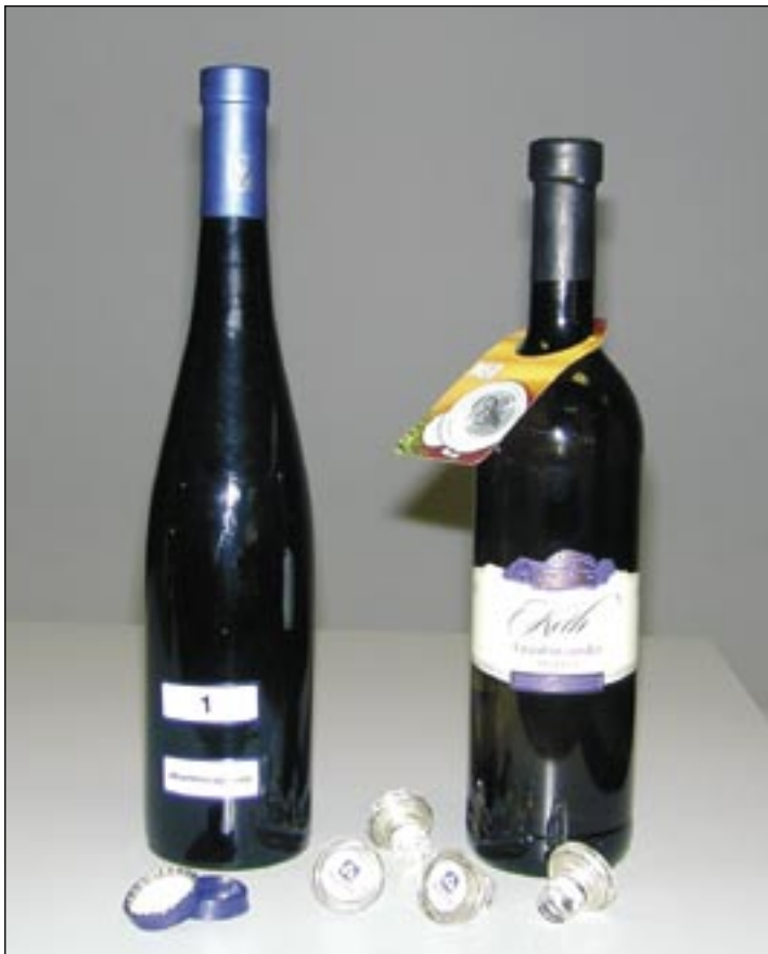
Flaschen mit zwei Verschlusssystemen im Vergleich: stainless cap (l.) und Vino Lok (r.)
