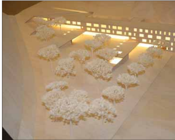
Der Bau geht terrassenförmig auf die vorhandene Topographie ein und ermöglicht getrennt Zugänge für verschiedene Nutzer.
