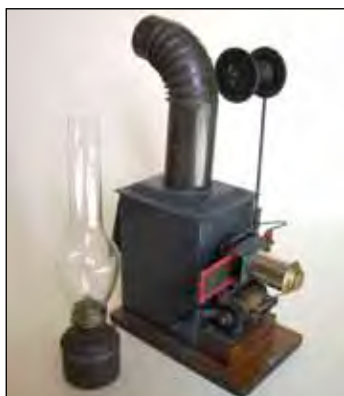
Uropas Dia- und Filmprojektor mit Kurbelantrieb, Petroleumlampe und Kaminabzug
