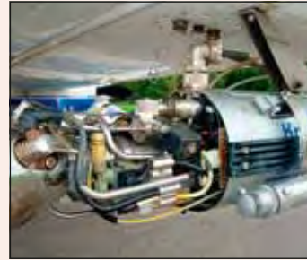
Im Generator entstehen Milliarden mikroskopisch kleine Eiskeime
