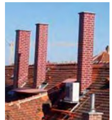
Als Kamine verkleidete Handyumsetzer. F: Dr. Dietrich Moldan
