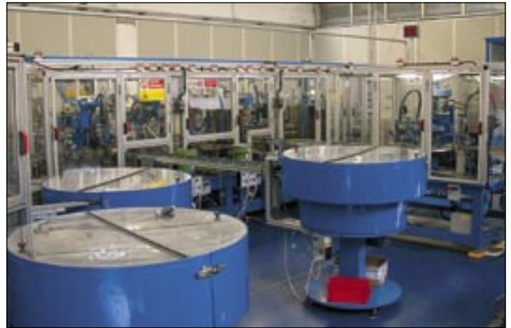
Maschine zur Zusammenstellung von Fertigteilen
