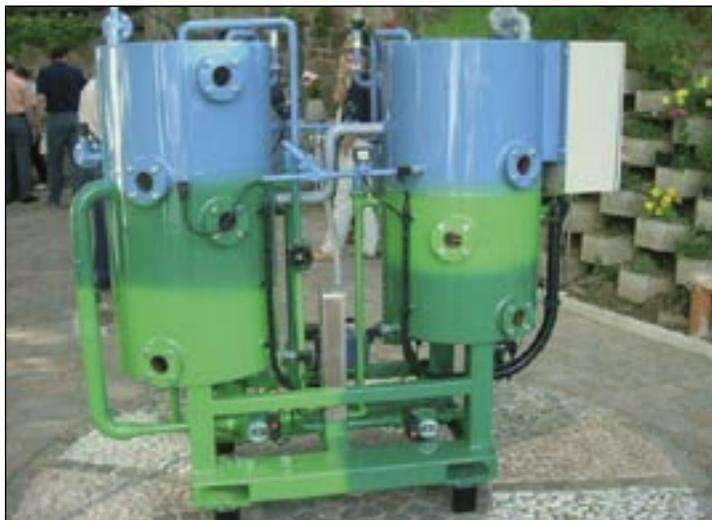
Kleinabsorber für solare Kühlung
