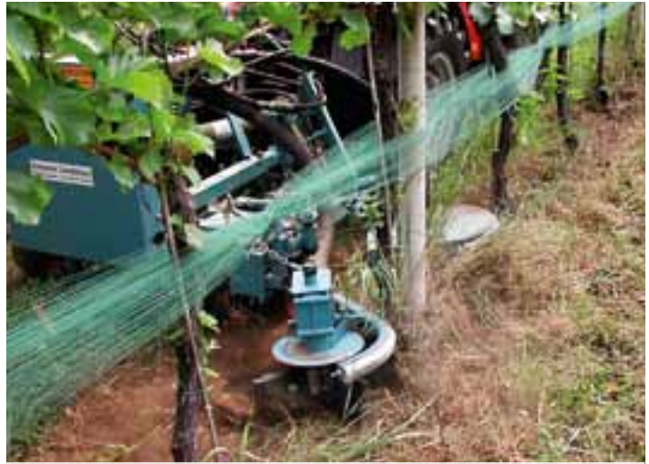
Unterstockgerät im Einsatz
