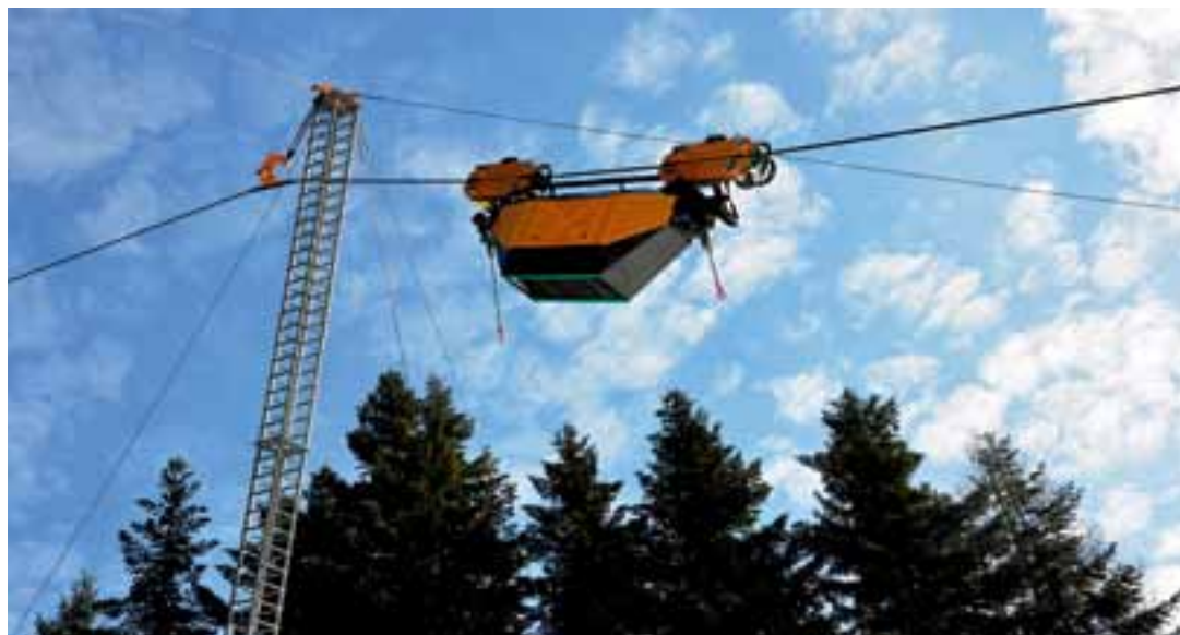
Der Revo Cable Tiger trägt eine Last von 5 Tonnen und bewegt sich völlig selbstständig auf dem Seil.
